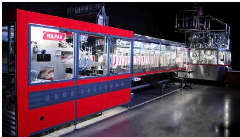
Die SC+ ist eine Beutelverpackungsmaschine mit kontinuierlicher Hochgeschwindigkeit. Bild: Volpak
